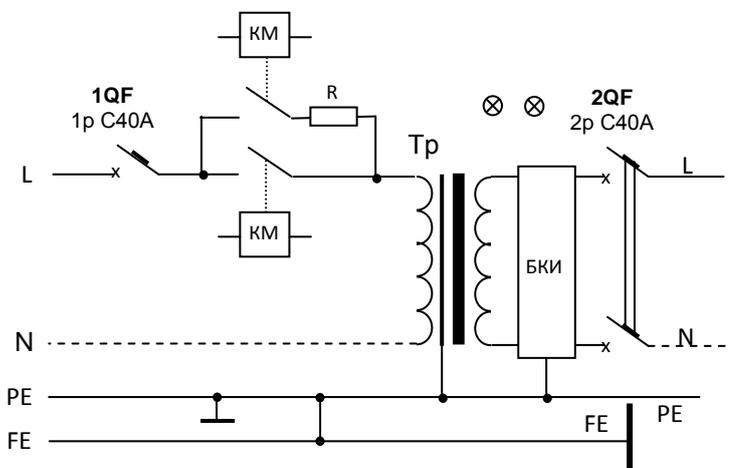
БКИ – блок контроля изоляции, температуры и тока нагрузки
