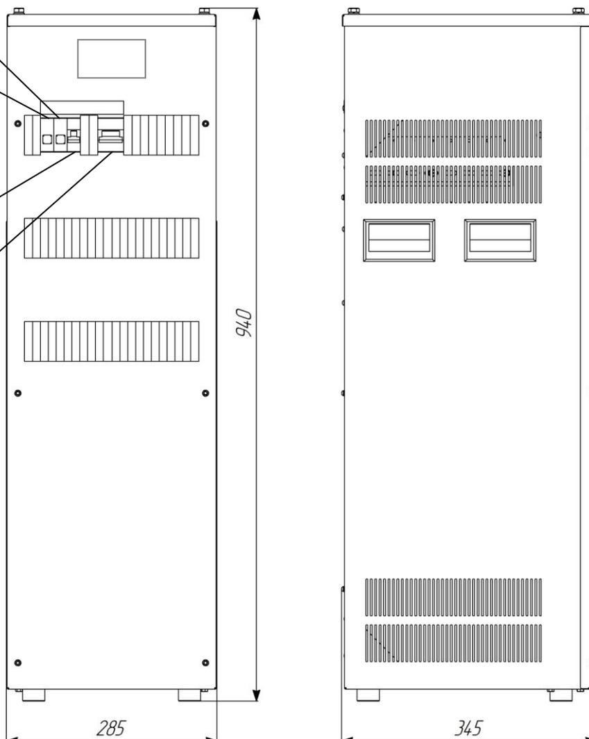
При установке изделия расстояние между шкафами > 100мм
